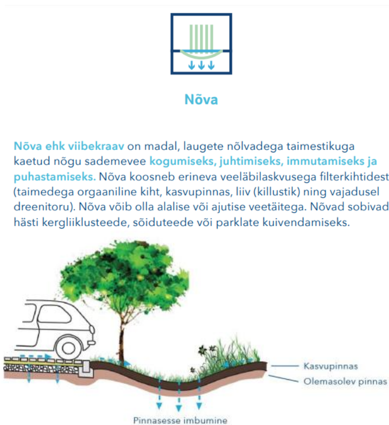
Joonis 15. Läbilõige nõvast koos vee liikumissuundadega. Läbides laugeid nõlvaid, väheneb vee voolukiirus ning äravool on ühtlane terve nõva ulatuses.
